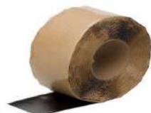
La bande QuickSeam™ Batten Cover de 152 mm de large est une bande d'EPDM semi-vulcanisé autoadhésif. Cette bande est utilisée pour assembler les membranes RubberCover entre elles, également la mise en œuvre des finitions type bande à ourlet et bande de rives.
